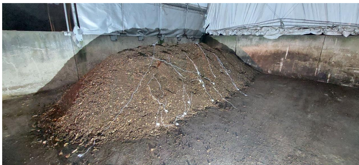
Figuur 2. Foto van de composthoop na opzet, de witte draden zijn verbonden met de temperatuursensoren.
